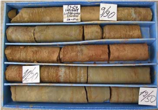
Sondeig 3, caixa 4: de -9,90 a -12,50 metres.
