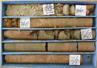
Sondeig 3, caixa 2: de -3,60 a -7,00 metres.
