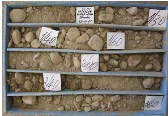
Sondeig 3, caixa 1: de 0,00 a -3,60 metres.
