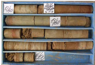
Sondeig 3, caixa 5: de -12,50 a -15,00 metres.
