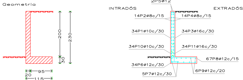
Detall Mur Armat de 2m. tipus - C
